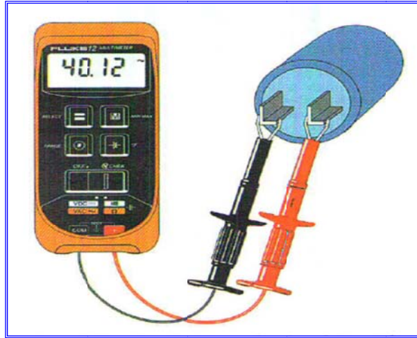
شكل (٣- ١٤) كيفية فحص المكثف
