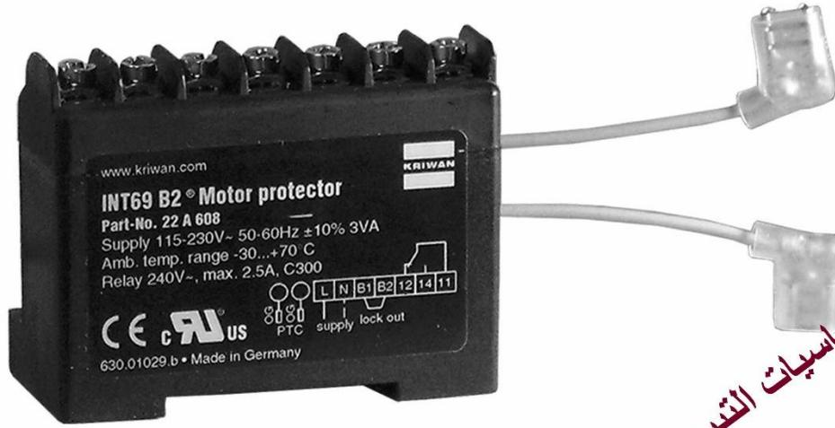
هذا الجهاز لحماية ملفات الكباس من التلف نتيجة ارتفاع امبير التشغيل او ارتفاع درجة حراره الكباس وهذا الاوفرلود كما هو في الشكل المقابل له طرفان يوصلان على الاوفرلود الداخلى لملفات الكباس وعند ارتفاع درجة حراره ملفات الكباس نتيجة ارتفاع الامبير او سخونه الملفات فان الاوفرلود الداخلى يقوم بالفصل ويقوم الاوفرلود الاليكترونى بفصل دائره كونترول الكباس ويتوقف عن العمل .
