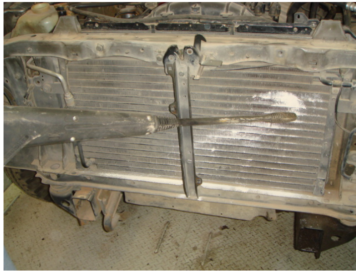
الشكل (٤ - ٤) يبين تنظيف المكثف بواسطة الماء والهواء المضغوط
