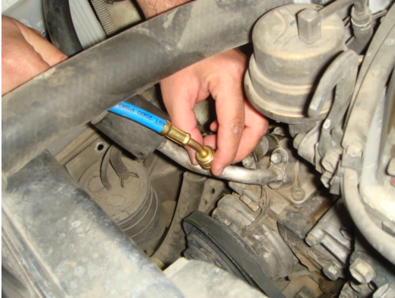
الشكل (٤ - ٣٠) يبين توصيل لي الضغط المنخفض الخاص بعداد المشعب بخط الضغط المنخفض بدورة
