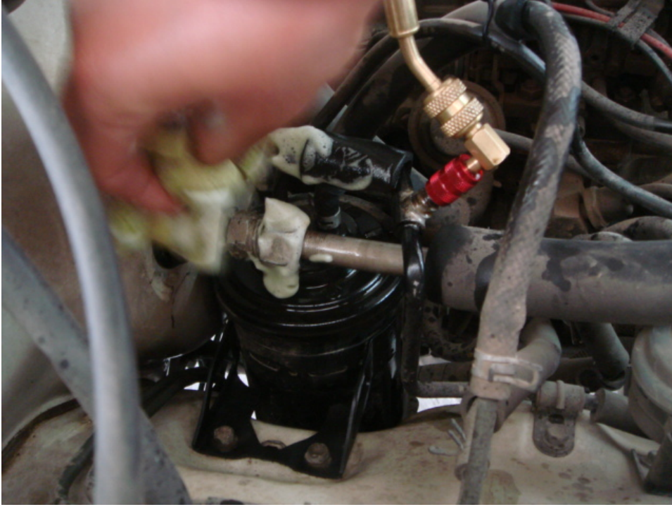
الشكل (٤ - ٢٤) يبين طريقة الكشف عن التسرب بدائرة التكييف بالمركبة بواسطة الصابون
