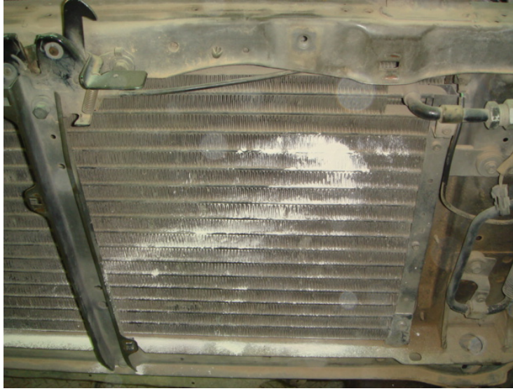
الشكل (٤ - ٣) يبين وجود أوساخ على المكثف
