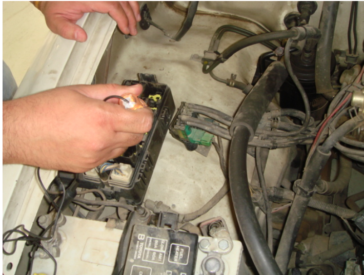
الشكل ( ٤ - ١٨ ) يبين فحص الفيوزات بواسطة لمبة الفحص
