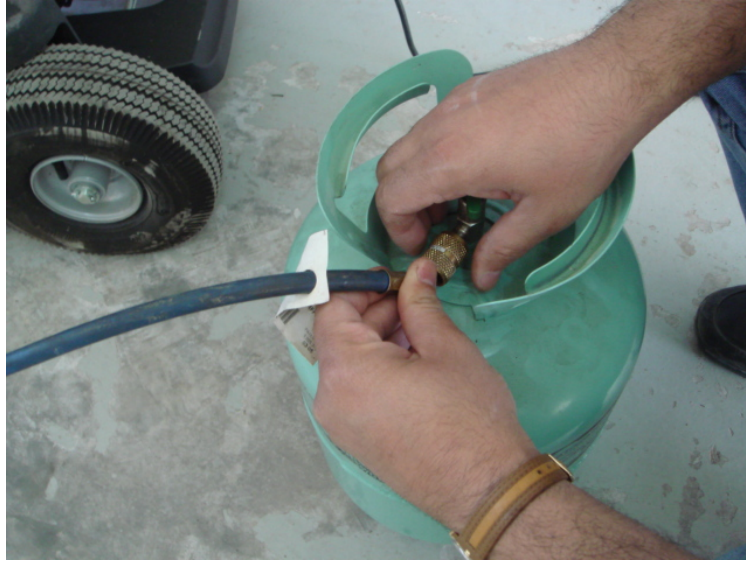
الشكل (٤ - ٢٩) يبين تركيب صمام حنفيه أسطوانة غاز التبريد
