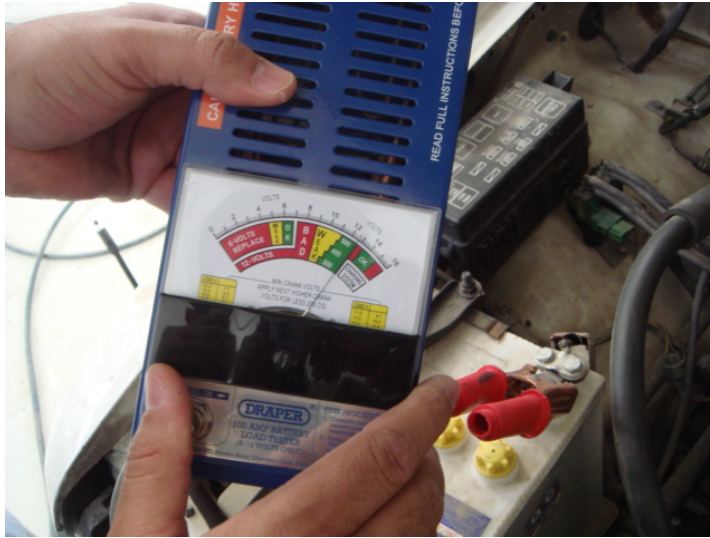
الشكل ( ٤ - ١٧ ) يبين فحص البطارية بواسطة جهاز الفحص
