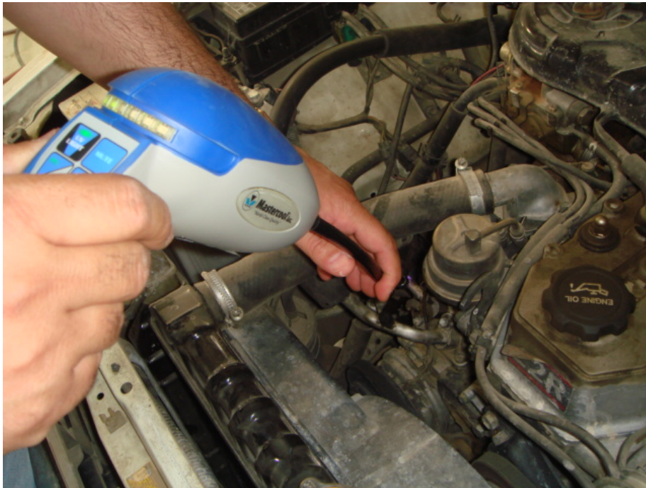
الشكل (٤ - ٢٣) يبين طريقة الكشف عن التسرب بدائرة التكييف بالمركبة بواسطة الجهاز
