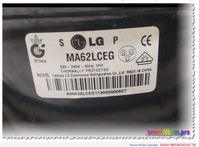
ضاغط LG MA62LCEG لديه قدرة تعادل 1/5 حصان (0.2 حصان) أو حوالي 150 واط. يتميز هذا الضاغط بكفاءة عالية في التبريد، حيث يستخدم غاز R134a ويعمل بتردد 50 هرتز مع جهد كهربائي يتراوح بين 220-240 فولت.
