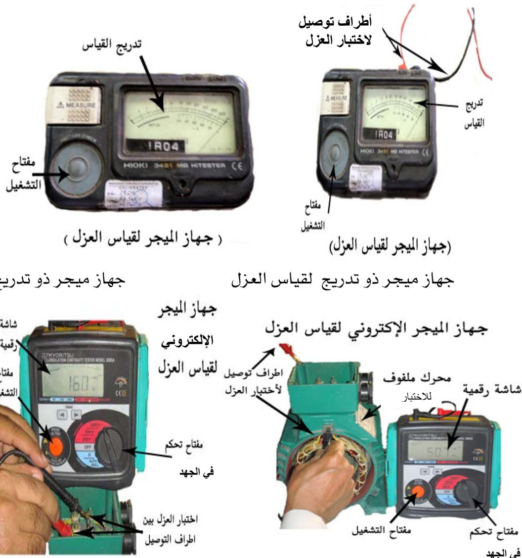
**الشكل (ب - ١٦ ) لنوعين من اشكال اجهزة قياس العزل ف منها الرقمي ومنها ذو التدريج**
